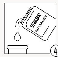
Шаг 4 - Нейтрализация кислотности теплообменника
