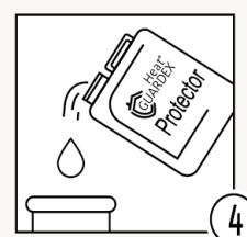
Шаг 4 - Залить защитный ингибитор в систему
